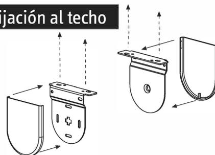
**2. Con un lápiz, marcar la perforación de 1 soporte, con una broca del diámetro del buje hacer la perforación y colocar los respectivos bujes. Después, colocar el soporte y fijarlo con los tornillos.**
