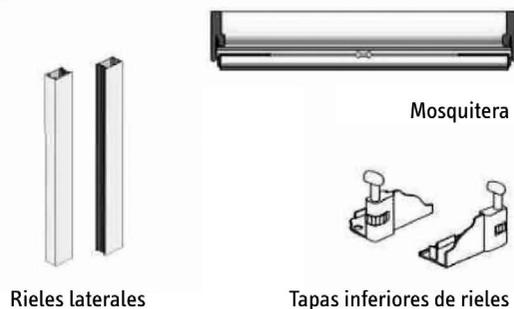
**2.** Regla general, la mosquitera es instalada dentro del vano. Dependiendo de la mosquitera puede ocurrir que sea necesario perforar los rieles y fijarlos lateralmente a la pared. Montar el conjunto de caja de recogida, rieles y tapas inferiores de los rieles, posicionarlos en el lugar cierto y marcar la perforación para la caja y para las tapas inferiores. Fijarlas con los tornillos adecuados.
